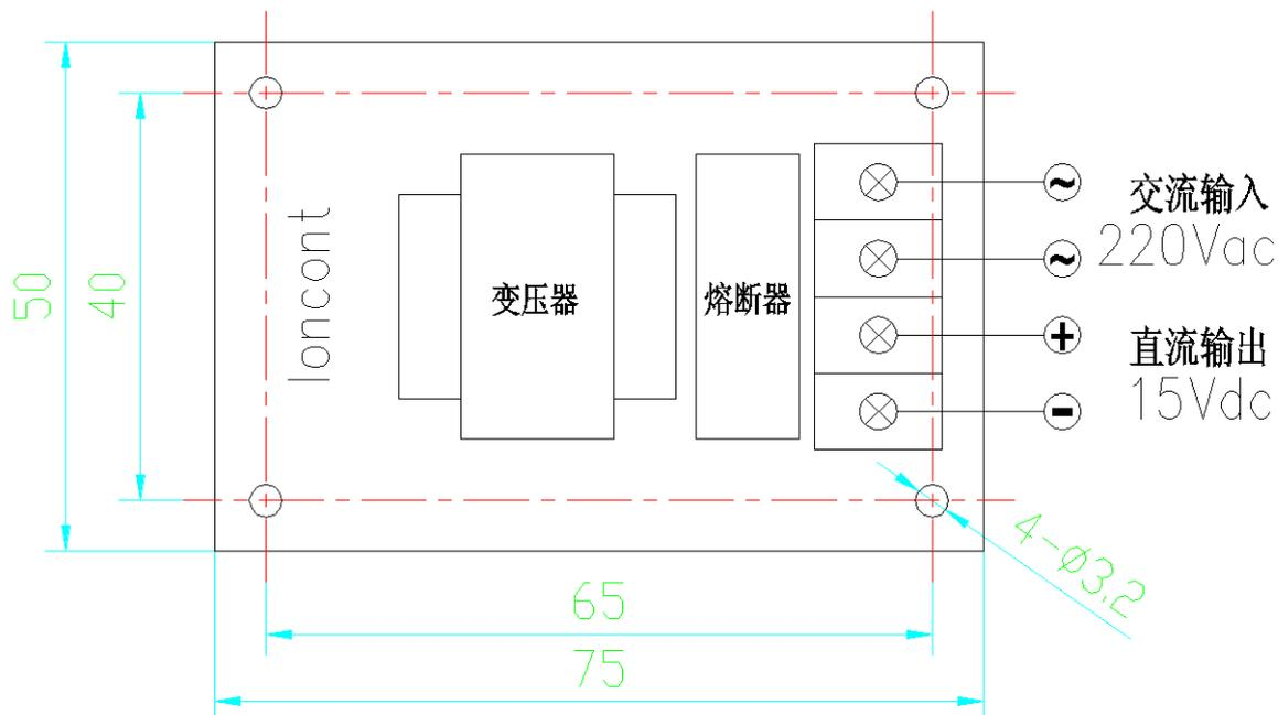
电源主要用于控制各类固态继电器、交直流电机正反转模块等场合。
