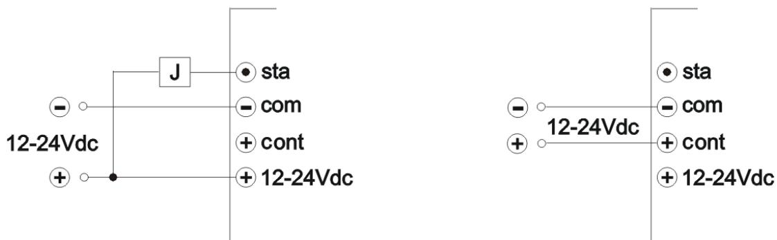
缺相保护型控制接法，J可接可不接
